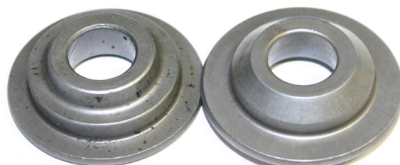
Härtegut: links bei UNFILTRIERTEM, rechts bei FILTRIERTEM Härtebad
