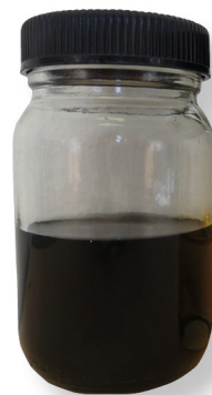
Ölprobe Transformator #1 ohne Filter nach 6 Wochen
