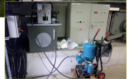
CJC® Filter Separator 27/27 als mobiles Ölpflegesystem
