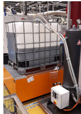
CJC® KSS-Filter zur Rückgewinnung des Schneidöls
