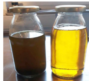
Nullprobe (li) und Probe mit CJC® KSS-Filter (re)
