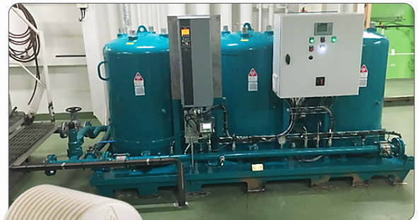
CJC® Ölpflegesystem 3x427/81 und integrierte CJC® Feinfilterpatrone LOX – speziell entwickelt für die Schmierölpflege an 2-Takt-Dieselmotoren
