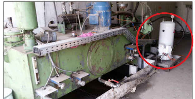
CJC® Feinfilteranlage installiert am Schmieröltank des Kegebrechers
