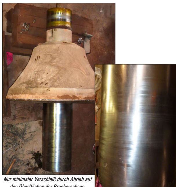
Nur minimaler Verschleiß durch Abrieb auf den Oberflächen der Laufbuchsen.
