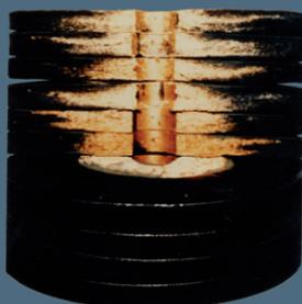
Schnittansicht einer gebrauchten CJC® Tiefenfilterpatrone
