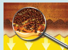
Die CJC® Tiefenfilterpatrone reinigt das Öl, bis die Fasern vollständig zugesetzt sind.
