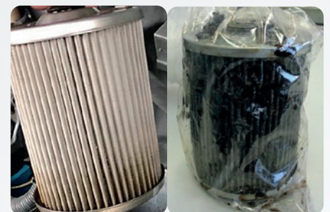
Ölfilter in der Hauptölleitung Fotos li: bei Einbau, re: verstopfter Filter
