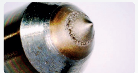
Kavitation und Korrosion bei Einspritzdüse
