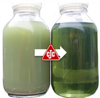
Nach erstem Filterdurchlauf Reinheitsklasse: 15/13/10 > 40 % weniger Partikel > 2 µm
