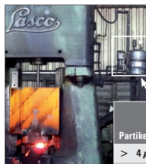
LASCO Gesenkschmiedehammer HOU 160 mit CJC® Ölpflegesystem 27/27
