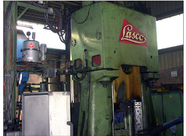
Lasco Gesenkschmiedehammer mit CJC® Ölpflegesystem 27/27
