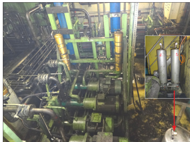
CJC® Ölpflegesystem 2P27/108 installiert im Maschinenraum der Schmiede Höhe zum Hydrauliktank: 10 Meter
