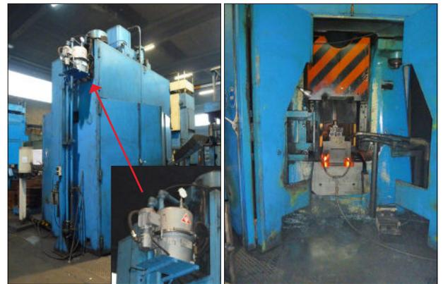
LASCO Gesenkschmiedehammer mit CJC® Ölpflegesystem 27/27
