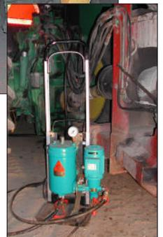
Fahrbarer CJC™ Feinfilter 15/25, angeschlossen am Hinterachsaggregat des Traktors.
