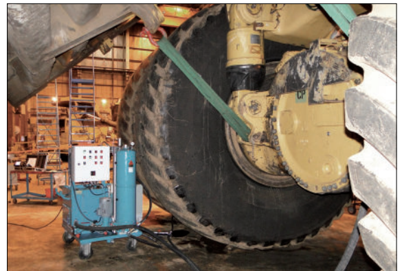
Die mobile CJC® Getriebespülanlage (MFU) ist hier zur Pflege des Getriebeöls und Spülung des Differentialgetriebes an einem Muldenkipper Typ Caterpillar 797 angeschlossen.
