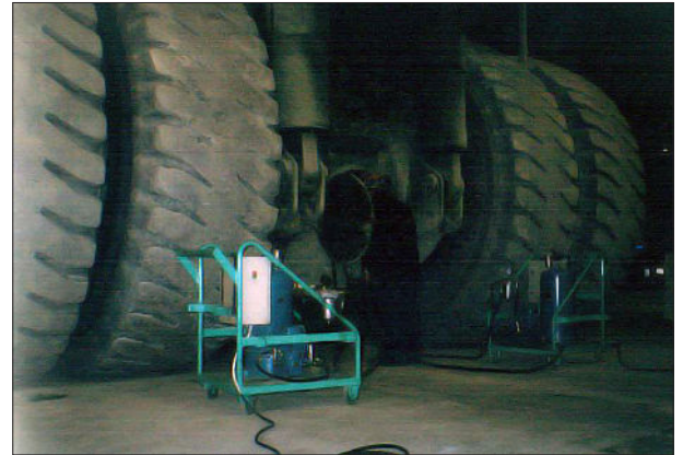
2 CJC® Ölpflegesysteme am Dresser Muldenkipper in der Mine "Los Bronces" in Chile
