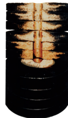
Querschnitt einer gebrauchten CJC™ Tiefenfilterpatrone
