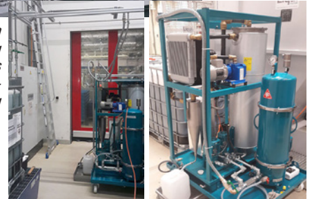
CJC® Ölpflegesystem zur Rückgewinnung des Bearbeitungsöls mittels Tiefenfiltration und Trocknung
