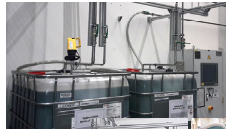
CJC® Ölpflegesystem zur Rückgewinnung des Bearbeitungsöls mittels Tiefenfiltration und Trocknung
