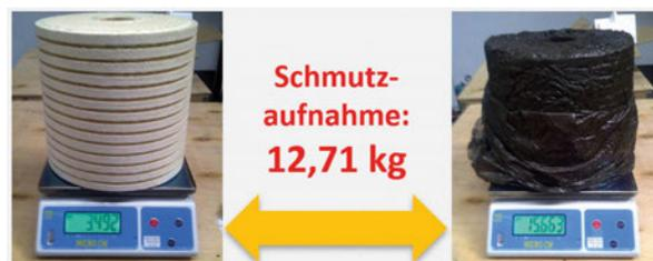
Da diese Filteranlagen im Nebenstrom rund um die Uhr laufen, wird die hohe Reinheit des Öls dauerhaft gehalten.
