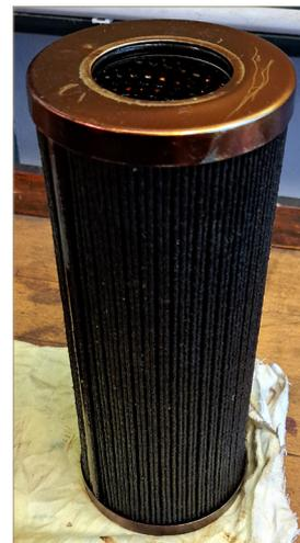
Oberflächenfilter des Druckfilters: entfernt Partikel, wird jedoch rasch infolge von Varnish zugesetzt.
