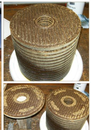
Fein- und Tiefenfilter des CJC® Ölpflegesystems: hält Varnish, Ölabbauprodukte sowie Feuchtigkeit und Partikel in der Tiefe des Filtermaterials zurück.
