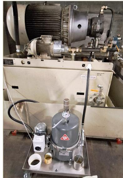
CJC® Ölpflegesystem 27/27 installiert am Öltankreservoir der Prüfmaschine
