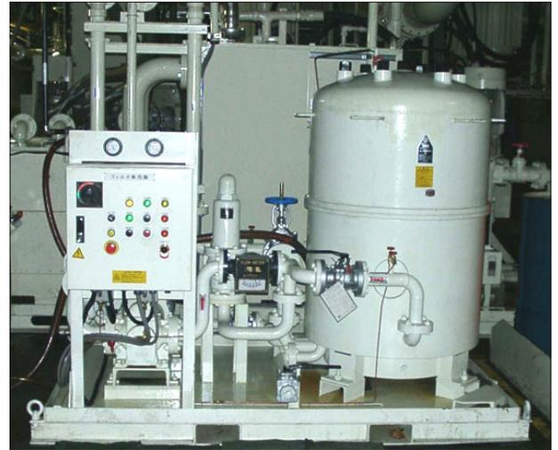
CJC™ Feinfilteranlage 727/108 an der Press- und Stanzmaschine
