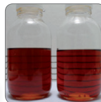
Sichtprobe Li: Öleintritt CJC™ VRU Re: Ölaustritt CJC™ VRU
