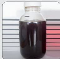
Turbinenöl VOR Filtration mit der VRU
