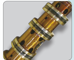
Ventilkolben mit Varnish
