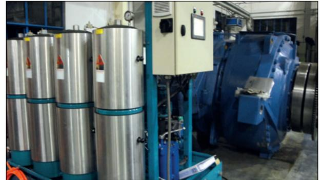
CJC™ Getriebespülanlage GFU 4x27/108 im Einsatz an einem Chongqing Getriebe
