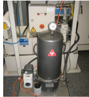
CJC® KSS-Filter zur Feinfiltration und Aufbereitung des Schleiföls installiert in einem unabhängigen Fluidkreislauf am Tank der Werkzeugmaschine.
