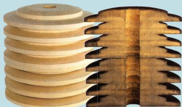
Der Querschnitt einer CJC™ Feinfilterpatrone nach 6 Monaten Einsatz im Vergleich zu einer sauberen CJC™ Feinfilterpatrone lässt deutlich den aufgenommenen Schmutz erkennen (siehe Fotos links).
