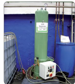
CJC™ Filter Separator installiert am IBC-Tank
