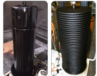
Bei einem Filterpatronenwechsel wird die extrem hohe Schmutzaufnahme sichtbar
