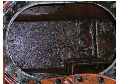
Dieseltank stark verunreinigt mit Schmutz, Schlamm und Wasser
