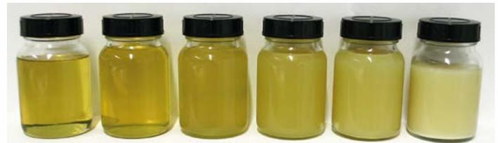
Hydraulikölproben mit unterschiedlichem Wassergehalt.
