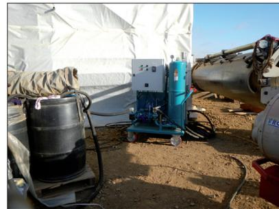
Mobiles CJC® Ölpflegesystem zur Feinfiltration und Pflege des Hydrauliköls – schnell und effizient während des Greiferwechsels.
