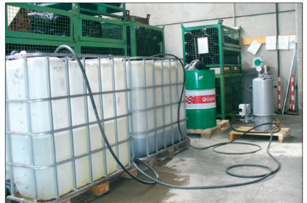
CJC® Ölpflegesystem 27/54 in Betrieb: die Tanks mit dem verschmutzten und dem sauberen Öl sind deutlich zu erkennen
