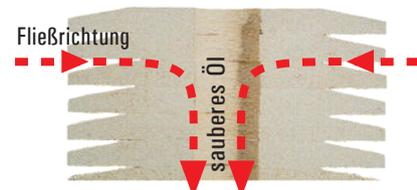
Querschnitt einer CJC™ Tiefenfilterpatrone
