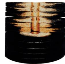
Querschnitt einer gebrauchten CJC™ Tiefenfilterpatrone
