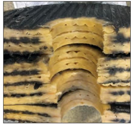
Fotos oben, links und mitte: Im Filterfuß sind deutlich die Anzeichen des starken Verunreinigungsgrades des Öls zu erkennen. Metallstücke, die groß genug sind, um bei dem relativ geringen Volumenstrom im Filterfuß zu sedimentieren, belegen den extrem schlechten Verschleißzustand des stark beschädigten Getriebes.
