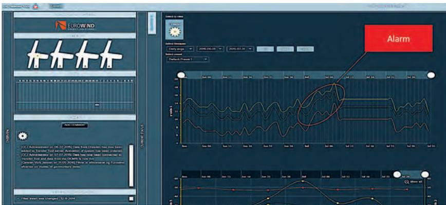
**Bild oben:** Daten aus dem CJC® T2Render Online-Monitoring-System zeigten deutlich die Entwicklung des Partikelgehalts und den Partikelanstieg, bei dem der Alarm an den Windenergieanlagen-Betreiber gesendet wurde.
