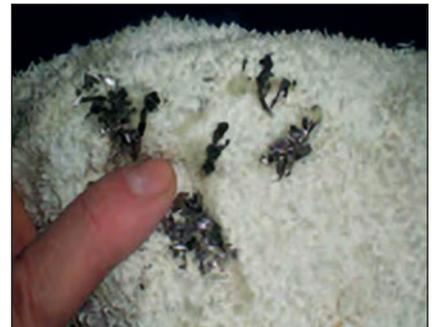
Bereits kurz nach Installation des zusätzlichen Filtersystems am 12. November 2014 konnte der kumulierte Gehalt an Partikeln > 4 µm in 100 ml Öl auf ca. 20.000 begrenzt werden, was einer Ölreinheit von ISO Code 15 entspricht. Eine Ölanalyse durch ein unabhängiges Labor bestätigte im Januar 2015 eine Ölreinheitsklasse von 14/13/9 (gemäß ISO 4407).
