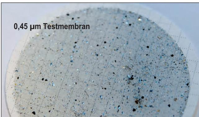
Bild unten: Vergrößerung (50-fach): Öl verunreinigt mit Buntmetallen (Messing, Kupfer) und Eisen aus Komponentenverschleiß (Partikelgröße: <1 µm bis 2 mm) sowie Ölalterungsprodukten (schwarze Ablagerungen < 5 µm)
