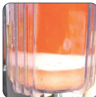
Abb. 16: Diesel mit Wasser und Bakterien
