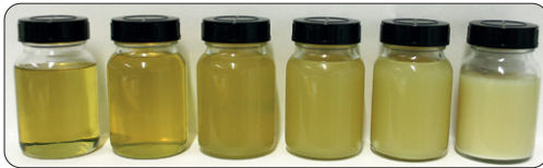
Abb. 23: Hydraulikölproben mit unterschiedlichem Wassergehalt Von links: 0,01 % - 0,03 % - 0,06 % - 0,1 % - 0,2 % - 2 %
