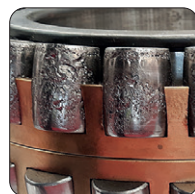
Abb. 12: Pittingbildung an einem Wälzlager
