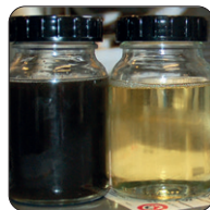
Abb. 34: Ölprobe vorher (li) und nach Installation eines kontinuierlichen Fein- und Tiefenfilters (re)
