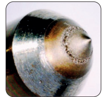
Abb. 45: Kavitation und Korrosion an einer Einspritzdüse
