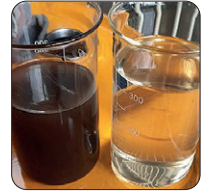
Abb. 31: Ölprobe vorher (li) und nach Installation eines kontinuierlichen Fein- und Tiefenfilters (re)
