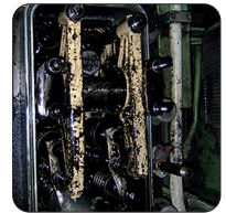
Abb. 43: Ruß und schlammartige Ablagerungen im Motorinnenraum
