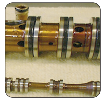
Abb. 32: Varnish-Ablage- rungen an Ventilen führen zu Fehlfunk- tionen
