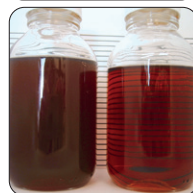
Abb. 35: Vorher-Nachher- Proben im Zuge der Ölrückgewinnung mittels Fein- und Tiefenfiltration oben: wasserhaltiger KSS unten: Bearbeitungsöl
