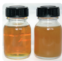
Abb. 8: Schmieröl mit unterschiedlichem Wassergehalt: (li) 0,025 % (kaum sichtbar) (re) 0,2 %
