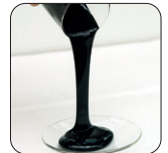
Abb. 22: Foto (oben): Frischöl Foto (unten): Viskositäts- änderung infolge von Ölalterung. Quelle: Oelcheck GmbH
