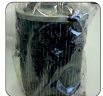
Abb. 44: verstopfter Ölfilter (Hauptleitung)
