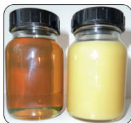
Abb. 9: Probe (li): Hydrauliköl mit gelöstem Wasser Probe (re): Emulsion
