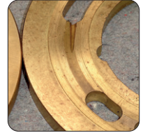
Abb. 5: Lager einer Axialkolbenpumpe mit Riefen
